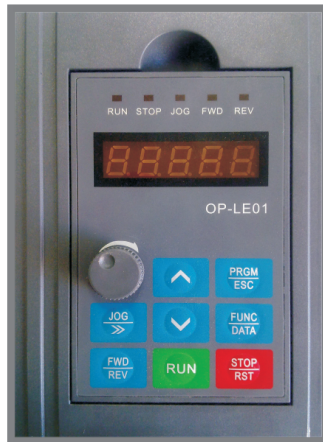
面板盒开孔尺寸(高*宽): 142*98mm 外框尺寸: 147*103
